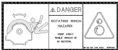
Fig.144738: Perigo de captura durante a operação de guinchos
